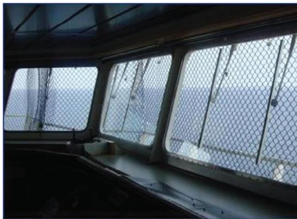
船橋窓フェンス
