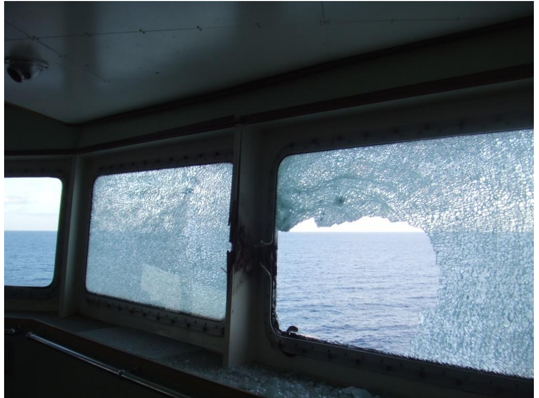
海賊の銃撃により割られた船橋前面の窓ガラス
