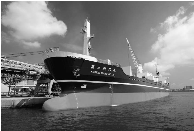
◀接岸中の石灰石専用船 第二興石丸
