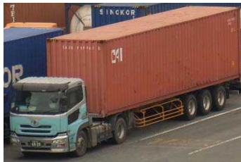
40フィートコンテナ(ISO規格) 長さ:40フィート(約12m) 最大積載量:30.48トン
