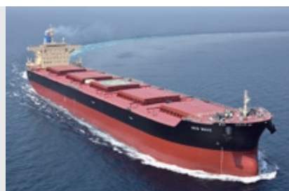
IRIS WAVE 49,905総トン／88,769重量トン／全長230m
