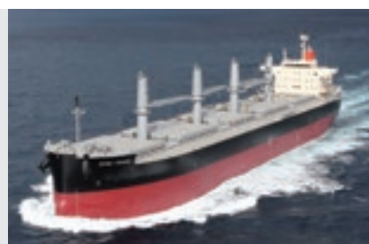
DYNA CRANE 31,482総トン／55,702重量トン／全長190m
