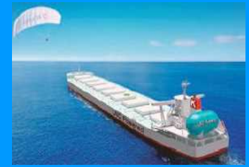
LNG燃料焚き・自動カイト システム搭載大型ばら積み船
