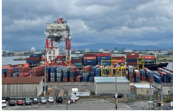
コンテナターミナルの様子。黄色の重機は、コンテナを運ぶストラドルキャリア。
