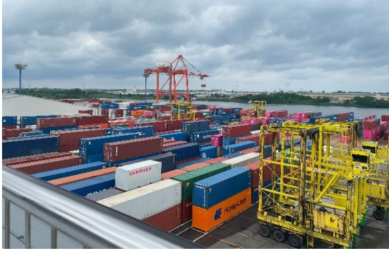
コンテナターミナルの様子。黄色の重機は、コンテナを運ぶストラドルキャリア。
